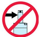
Eine übermäßige seitliche Belastung der Ausgangsschubstange des Aktuators verringert die Lebensdauer des Aktuators drastisch und sollte vermieden werden. Seitliche Belastung kann durch Fehlausrichtung oder Belastung verursacht werden, die nicht in einer Linie mit der Ausgangsschubstange des Aktuators liegt.
