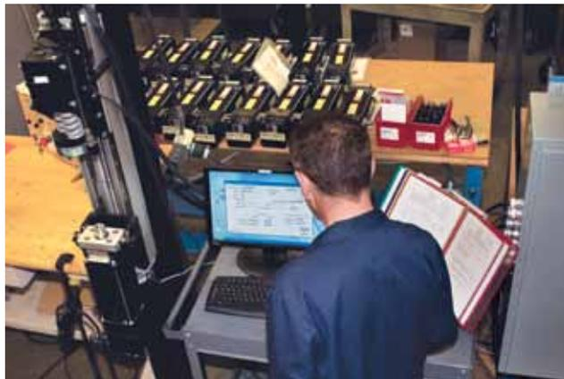
350サイクルでの機能ユニット検査は、ストローク、長さ、無負荷トルク、入力電流対力標準偏差を定量化します。
