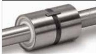
重荷重を処理可能。力は、微細なねじ付きローラーねじでかみ合うマルチねじ付きヘリカルローラーアセンブリによって伝達されます。ローラーねじには、多くの接触点に基づいて特別の負荷能力があります。
